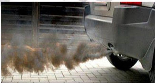
Las emisiones de motores diésel son una mezcla de partículas compleja, aerosoles líquidos, gases y vapores que se genera durante el funcionamiento de motores que utilizan el gasóleo como combustible.
